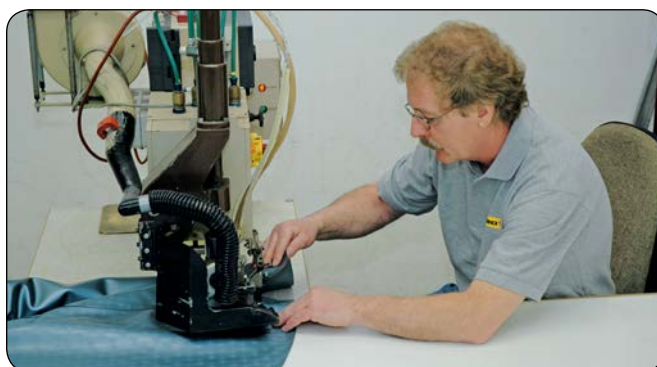
Soudure des lés en plastique avec la soudeuse à panne chauffante
