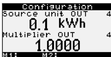
**Actif uniquement lorsque le module d'entrée numérique est branché sur le port d'extension 1. Ce menu doit être activé à l'aide du Superprog Windows.**
