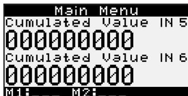
Actif uniquement lorsque le module d'entrée est branché sur le port d'extension 2. Ce menu doit être activé à l'aide du Superprog Windows.
