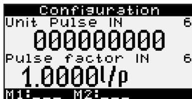
**Actif uniquement lorsque le module d'entrée numérique est branché sur le port d'extension 2. Ce menu doit être activé à l'aide du Superprog Windows.**
