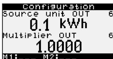
**Uniquement actif lorsque le module numérique de sortie est connecté au port d'extension 2. Ce menu doit être programmé à l'aide de Superprog Windows.**
